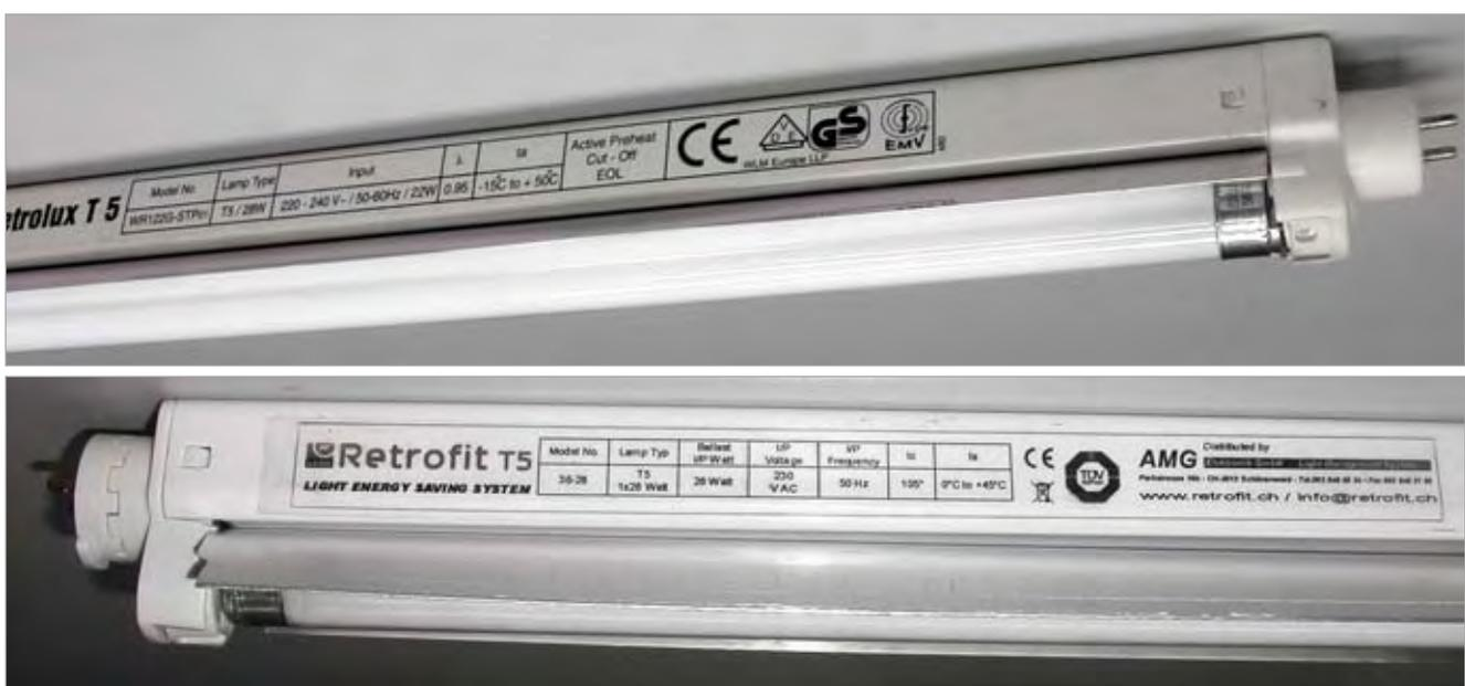
**Bild 1** Zwei Adaptersysteme, mit denen in bestehenden T8-Leuchten die kürzeren T5-Lampen betrieben werden. Der Einsatz dieser Systeme ist fragwürdig, da die Lampen nicht optimal betrieben werden, die Lebensdauer und Lichtausbeute reduziert und damit die Wirtschaftlichkeit nicht gegeben ist.
