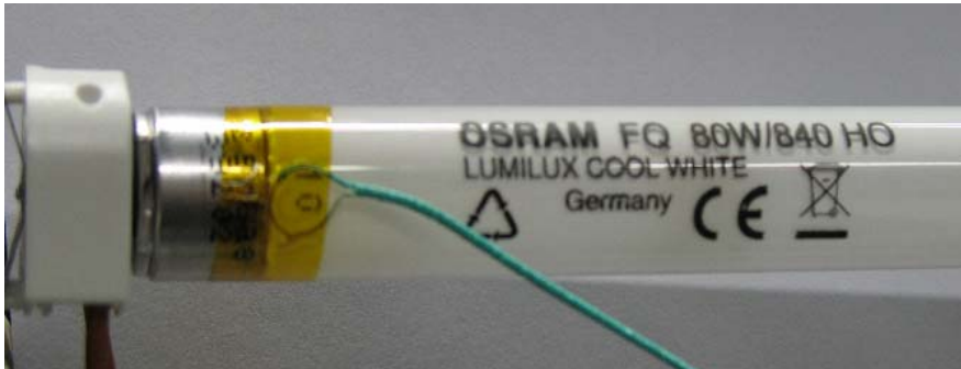
Bild 1: Kühlstelle einer T5 Lampe
