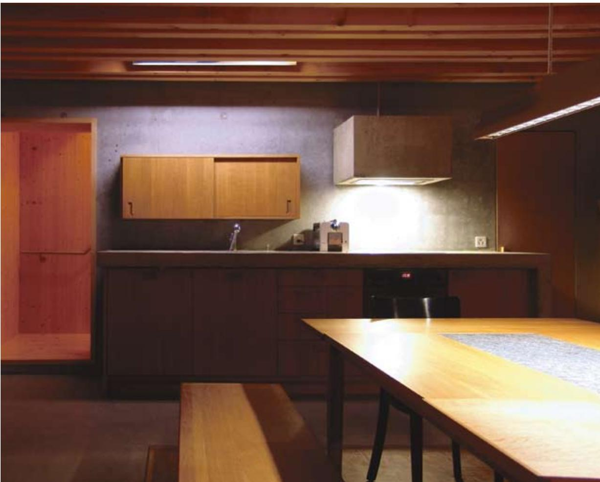
Blick in den Hauptraum im Erdgeschoss. Die hängende Spiegelrasterleuchte Evio von Zumtobel (54 Watt) schneidet eine Lichtinsel aus dem Raum, ohne die Personen am Tisch mit Direktlicht zu belästigen. An der Decke ist eine «Spina» von Ribag montiert, die beim Kochen hilft, und unter dem mit Beton verkleideten Dampfzug leuchtet eine Dulux EL Vario von Osram mit 11 Watt Leistung. (Stefan Gasser)
