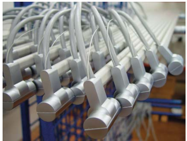
ABS-Kunststoffteile verbinden Stromkabel, Aluträgerprofil und Lampenfassung.
