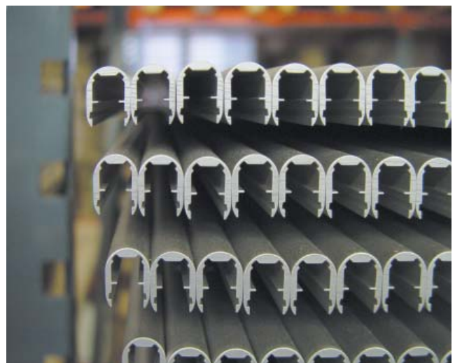
Gezogene Aluprofile bilden das Rückgrat der Spina. Der Hohlraum dient zur Kabelführung.
