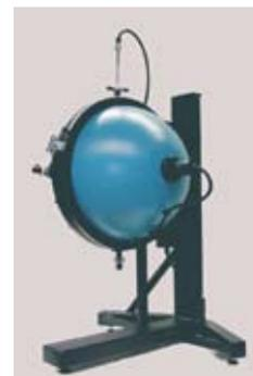
In der Ulbricht'schen Kugel werden Lichtstrom und Aufstartzeit gemessen. Es ist eine innen diffus reflektierend beschichtete Hohlkugel mit einem Durchmesser von 50 cm bis 100 cm. Ein seitlich an der Kugel angebrachter Messkopf misst den gesamten, von der Testlampe abgegebenen Lichtstrom. Durch die Vielfachreflexion des Lichtes innerhalb der Kugel kann dieser Lichtstrom verlustfrei vom Sensor eingefangen werden. (Stefan Gasser)
