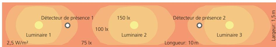
Coupe d'un couloir avec luminaires et courbes Isolux
